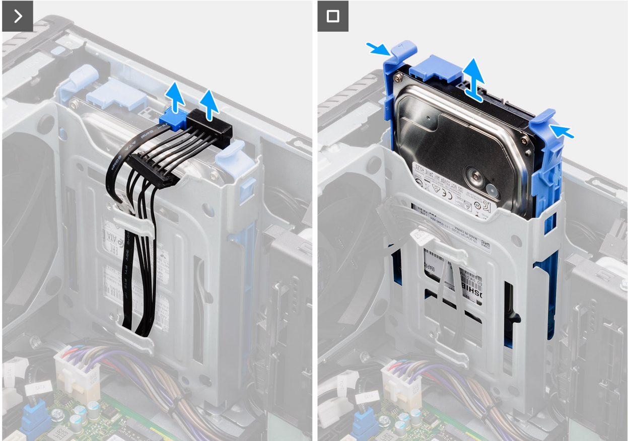
Obrázek 16. Demontáž sestavy 3,5palcového pevného disku ze zásuvky 1
