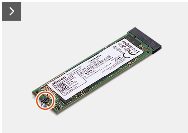
Obrázek 24. Demontáž disku SSD M.2 2280 PCIe
