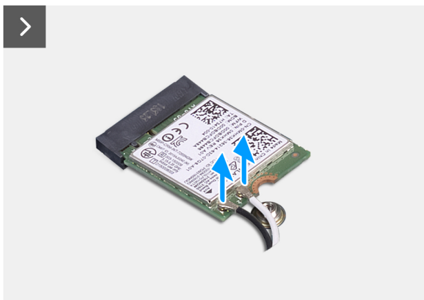
Obrázek 19. Demontáž bezdrátové karty
