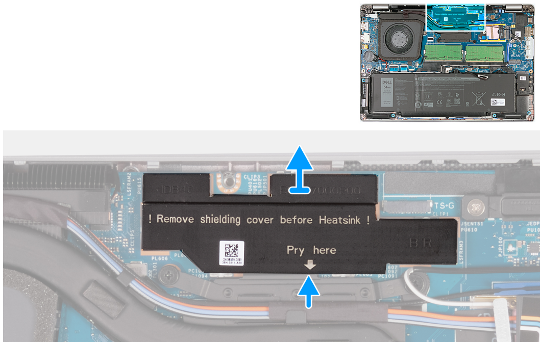
Obrázek 31. Demontáž stínícího krytu napájení – pro počítače dodávané se základní deskou H28 UMA
