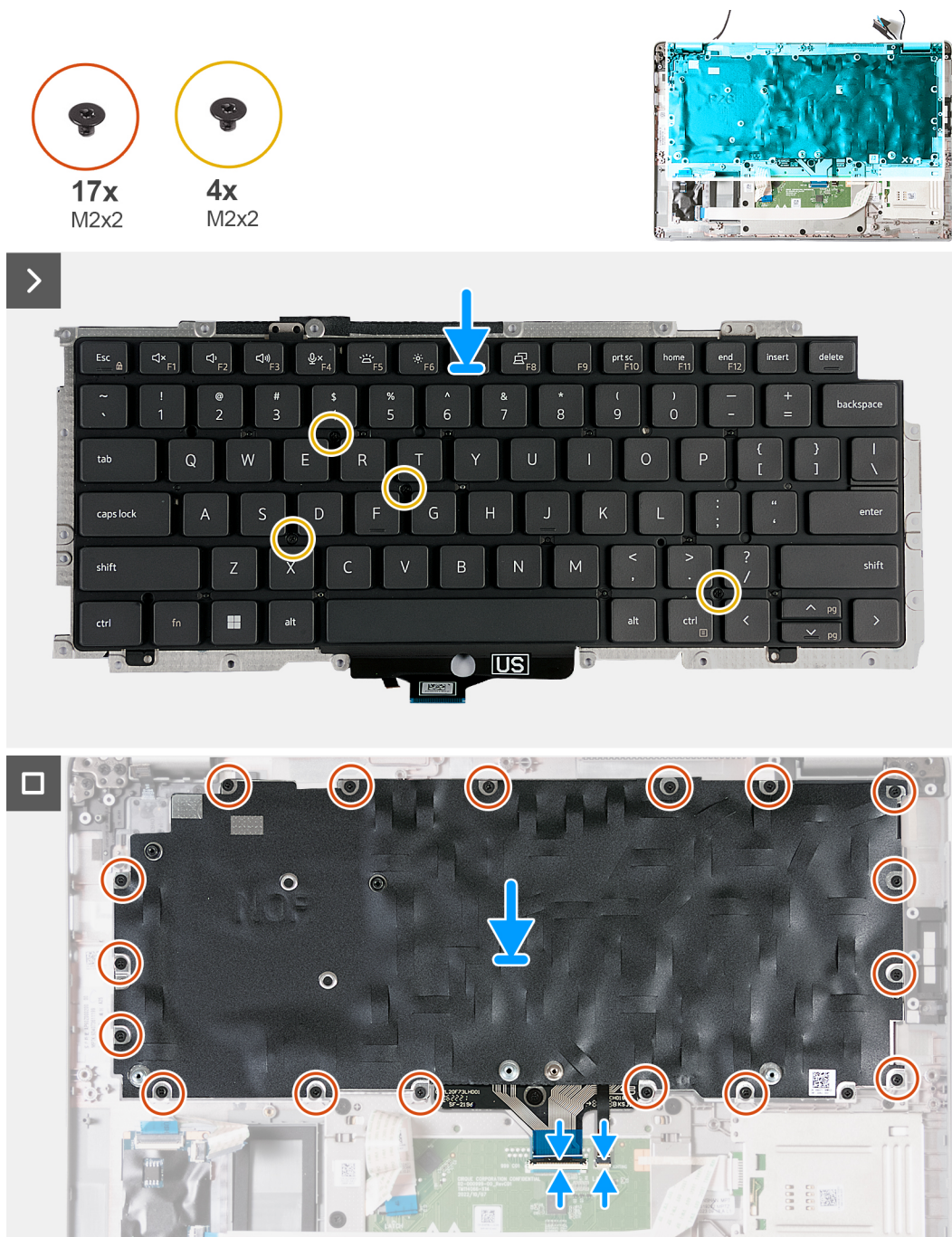
Obrázek 81. Montáž klávesnice
