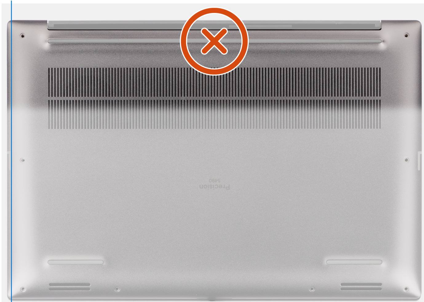
Obrázek 31. Neuvolňujte jej z horní strany spodního krytu
