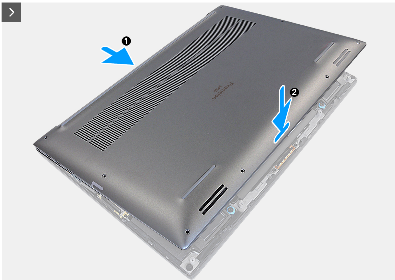
Obrázek 32. Nasazení spodního krytu
