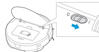
3. Umiestnite vysávač na dokovaciu stanicu a uistite sa, že sa nabíjacie kontakty dotýkajú. Začne blikáť biele svetlo, čo znamená, že sa robot nabíja.
