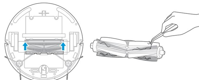
3. Očistěte kartáčový válec pomocí jemného hadříku nebo teplé vody. Nechte **DŮKLADNĚ** vyschnout a vraťte jej na místo.
