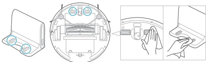
Otřete nabíjecí terminály na robotu i nabíjecí stanici měkkým hadříkem, jak je znázorněno na obrázku.
