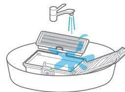
5. Промойте пылесборник, губчатый фильтр и фильтр теплой водой. ТЩАТЕЛЬНО просушите в течение 24 часов.
