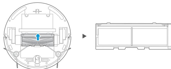
1. Otočte vysavač, vložte palec do otevřené zdířky mezi dvěma štítky a zvedněte ho tak, abyste vyjmuli kryt kartáčového válce.
