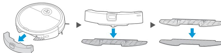
1. После завершения влажной уборки нажмите кнопку отсоединения резервуара для воды и снимите его с пылесоса. Отсоедините держатель салфетки для мытья пола от резервуара и снимите салфетку для мытья пола с держателя.
