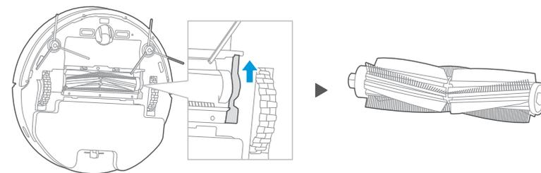
2. Нажмите и поднимите фиксатор роликовой щетки, чтобы извлечь щетку.
