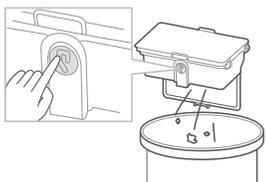
3. Stlačením tlačidla na uvoľnenie nádoby na prach ju vyprázdniť do odpadkového koša.
