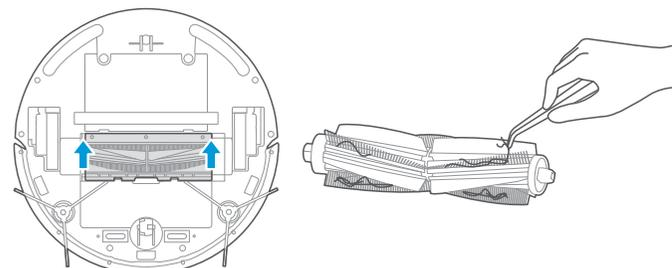
3. Очистите роликовую щетку мягкой тканью или теплой водой. ТЩАТЕЛЬНО просушите и установите на место.
