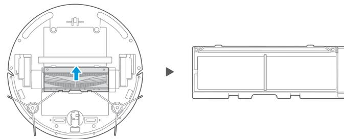
1. Переверните пылесос. Большим пальцем нажмите между двумя язычками и потяните крышку роликовой щетки вверх и снимите.
