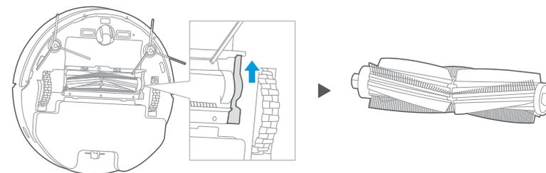
2. Stiskněte zámek kartáčového válce a zvedněte ho, abyste se dostali ke kartáčovému válci.
