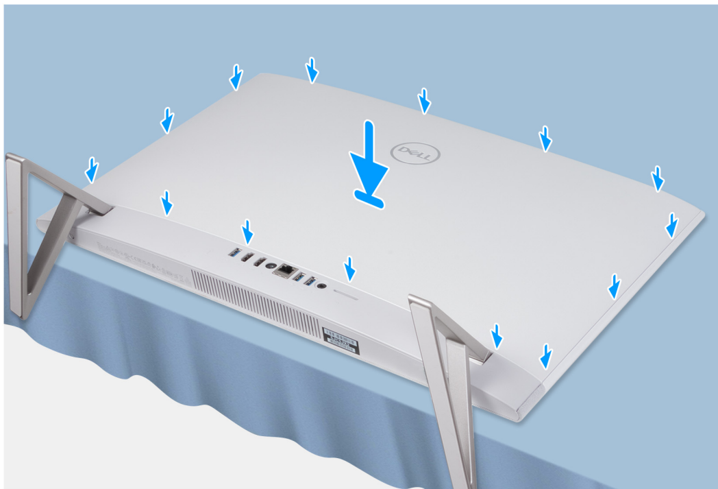
Obrázek 21. Montáž zadního krytu
