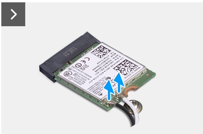
Obrázek 32. Demontáž bezdrátové karty
