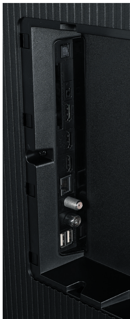
Konektory jsou na zadní straně uloženy tak, že ani při nástěnné montáži nebudou překážet.
