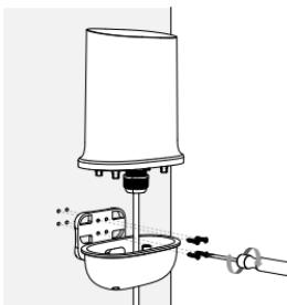
4. Fixez le DWP-1010 au mur à l'aide des vis M3 x 4mm (4 pièces).
