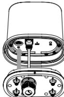
2. Wsuń gumową uszczelkę na kabel RJ-45, następnie umieść na uszczelce plastikowy klips.
