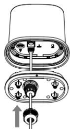
4. Obróć nakrętkę złącza zgodnie z ruchem wskazówek zegara, aby dokręcić ją do pokrywy.
