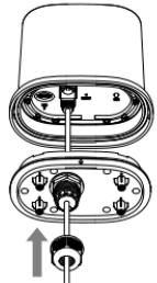
4. Tournez le cache connecteur dans le sens des aiguilles d'une montre pour le fixer au panneau
