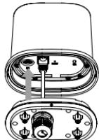
6. Fixați placa impermeabilă la dispozitiv folosind șuruburile M2,5 x 6 mm (6 buc)
