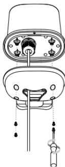
9. Nainštalujte spony z nerezovej ocele na DWP-1010 a voľne ho pripojením k stípu. Naskenujte QR kód zo štítku zariadenia M15 pomocou mobilného zariadenia a pripojte sa k DWP-1010. Otvorte aplikáciu Falcon a upravte polohu zariadenia na optimalizáciu kvality signálu. Nakoniec zariadenie pevne pripojením k stípu.
