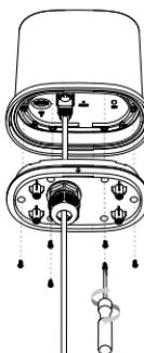
3. Nasuń nakrętkę na gumową uszczelkę i plastikowy klips.
