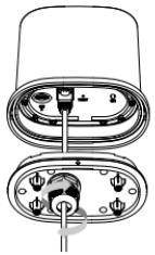
5. insérez la carte SIM dans le slot SIM (veuillez vérifier la taille de la carte SIM avant de l'insérer).
