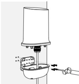
4. Fixați DWP-1010 pe perete folosind șuruburi M3 x 4 mm (4 buc).
