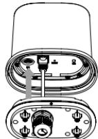
6. Připevněte vodotěsnou desku k zařízení pomocí šroubů M2,5 x 6 mm (6 ks)
