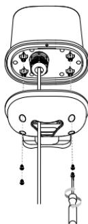
9. Nainstalujte spony z nerezové oceli na DWP-1010 a volně jej připevněte ke sloupu. Otevřete aplikaci Falcon a postupujte podle pokynů. Nakonec zařízení pevně připevněte ke sloupu.
