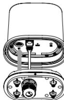
6. Fixez la plaque étanche à l'appareil à l'aide des vis M2,5 x 6mm (6 pièces).
