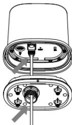
2. Nasuňte sestavu vodotěsné silikonové spojky na kabel RJ45 a zatlačte ji do desky.
