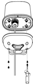
9. Installez les colliers de serrage en acier inoxydable sur le DWP-1010 et fixez-le au mât sans le serrer trop fort. Ouvrez l'application falcon et suivez les instructions. Pour finir, fixez fermement l'appareil au mât.
