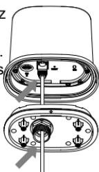
2. Glisser le clip en silicone étanche sur le câble RJ45 et l'enfoncer dans la plaque.
