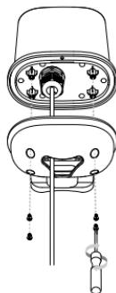
9. Zamontuj obejmy rurowe na DWP-1010 i luźno przykręcij go do słupa. Otwórz aplikację Falcon i postępuj zgodnie z instrukcjami. Na koniec dokręć śruby, aby stabilnie przymocować urządzenie do słupka.
