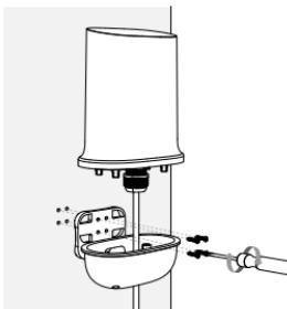
4. Připevněte DWP-1010 ke stěně pomocí šroubů M3 x 4 mm (4 ks).
