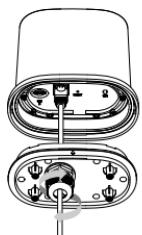
5. Vložte SIM kartu do slotu SIM karty (před vložením zkontrolujte velikost SIM karty).
