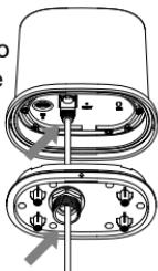
2. Nasuňte zostavu vodotesnej silikónovej spojky na kábel RJ45 a zatlačte ju do dosky.
