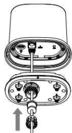
6. Przymocuj wodoodporną pokrywę do urządzenia za pomocą śrub M2,5 x 6mm (6 szt.)
