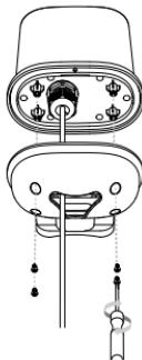
9. Instalați clemele din oțel inoxidabil pe DWP-1010 și fixați-l fără a strânge foarte tare pe stâlp. Deschideți aplicația Falcon și urmați instrucțiunile. În cele din urmă, fixați dispozitivul strâns pe stâlp.
