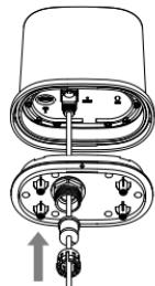
3. Glisați capacul conectorului pe ansamblul clemei din silicon.
