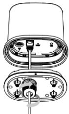
5. Introduceți cartela SIM în slotul SIM (vă rugăm să verificați dacă dimensiunea cartelei SIM este cea potrivită înainte de a o introduce).
