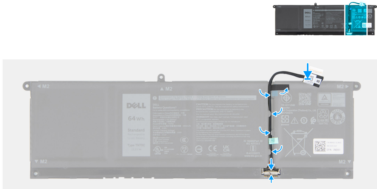
Obrázek 18. Montáž kabelu baterie
