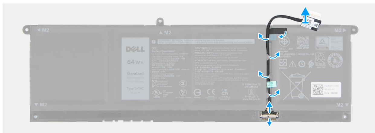
Obrázek 17. Demontáž kabelu baterie
