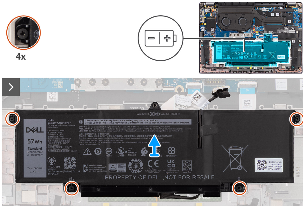
Obrázek 32. Demontáž 3člávkové baterie
