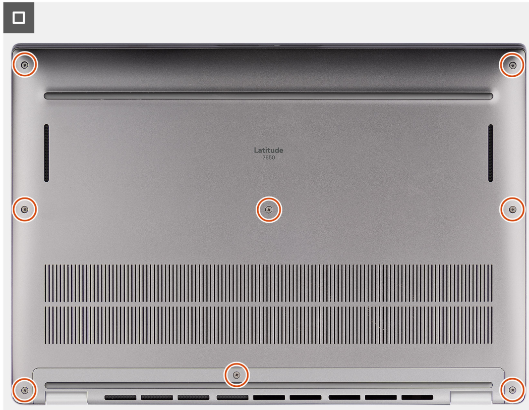
Obrázek 17. Nasazení spodního krytu
