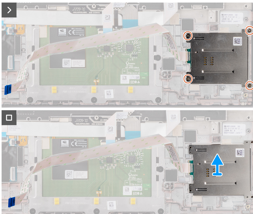
Obrázek 46. Demontáž čtečky čipových karet
