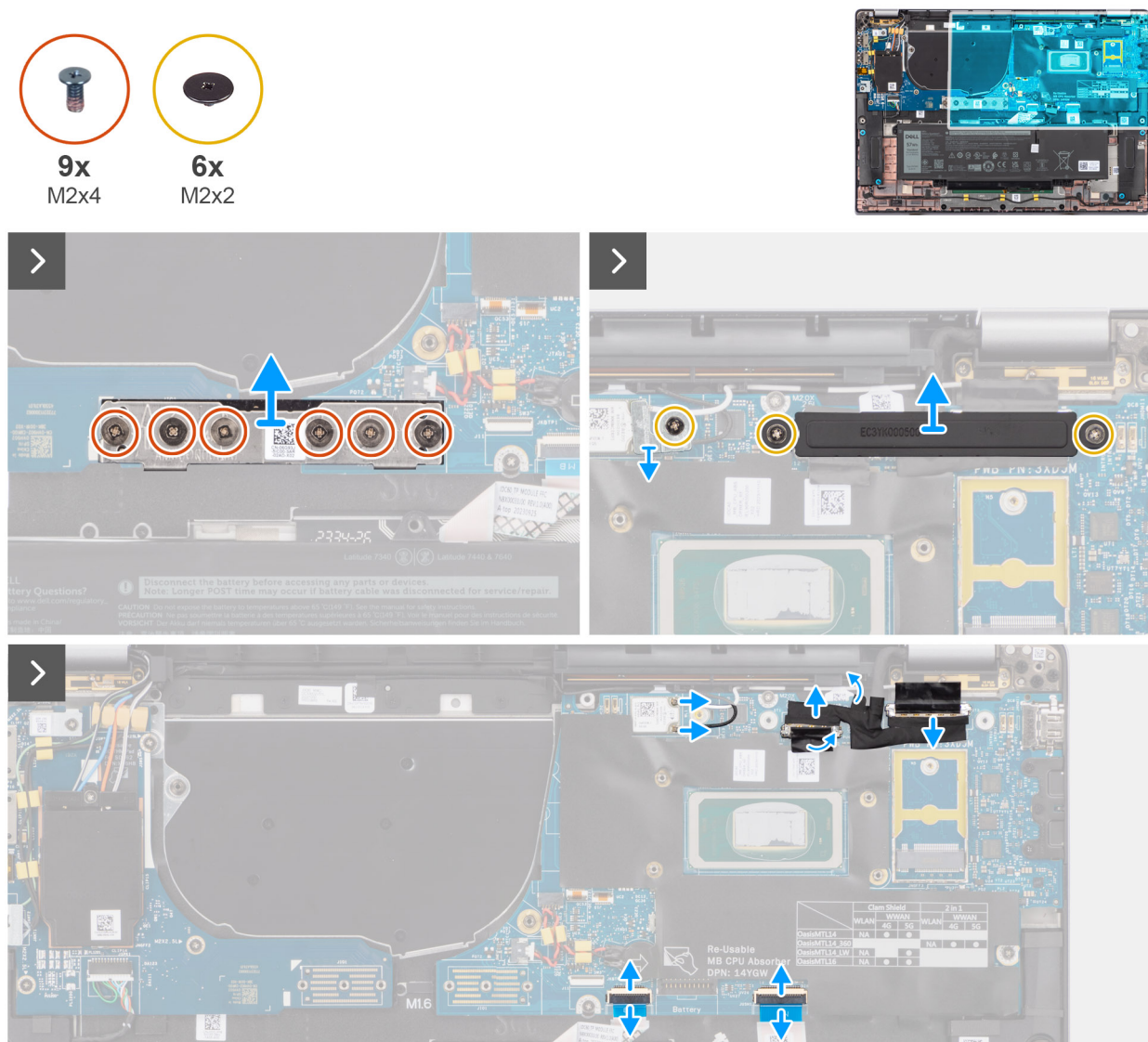
Obrázek 50. Demontáž základní desky
