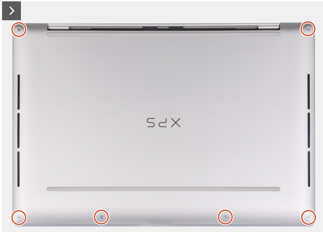
Obrázek 13. Sejmutí spodního krytu
