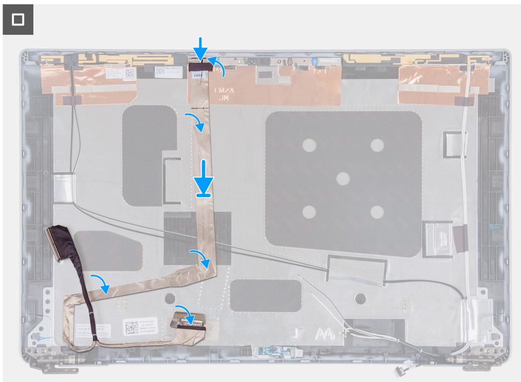
Obrázek 91. Vložení kabelu displeje
