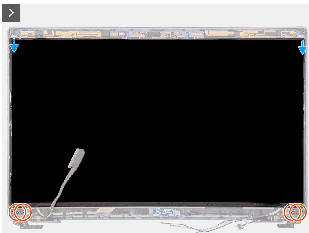
Obrázek 76. Demontáž obrazovky displeje
