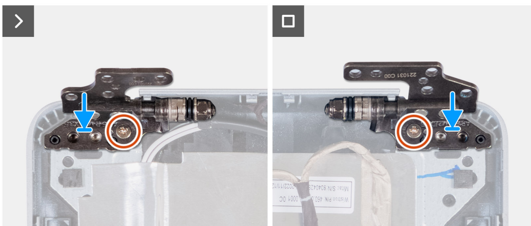
Obrázek 87. Montáž pantů displeje
