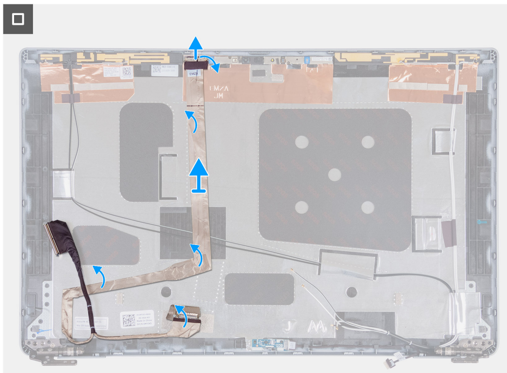
Obrázek 90. Vyjmutí kabelu displeje
