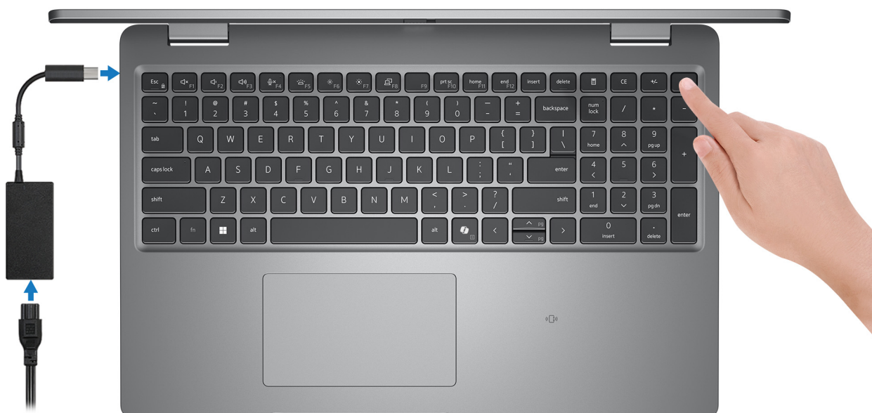
Obrázek 8. Připojte napájecí adaptér a stiskněte vypínač.
