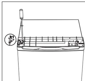
13. Nasadte horný kryt a upevnite ho pomocou 2 skrutiek na zadnej strane.
