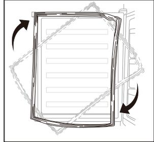
12. Helyezze vissza az ajtót! Mielőtt teljesen rögzíti a csavarokat, ellenőrizze az ajtó függőleges és vízszintes oldalát és a tömítés megfelelő működését!
