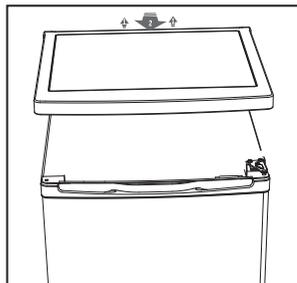
3. Odšroubujte horní závěs, odejměte dveře a položte je na měkkou podložku, aby se nepoškrábaly.
