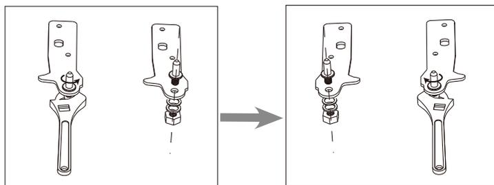
10. Instalujte konzoly na spodní závěs. Vraťte zpět obě nastavitelné nožky
