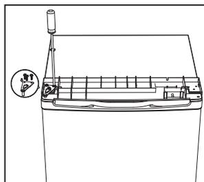
13. Nasadte horní kryt a upevněte jej pomocí 2 šroubů na zadní straně.
