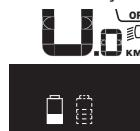
Jeżeli w rowerze elektrycznym z dwoma akumulatorami ładowane są obydwa akumulatory, na wyświetlaczu pojawia się wskazanie postępu ładowania dla obydwu akumulatorów (ilustracja pokazuje ładowanie lewego akumulatora). Migający wskaźnik na akumulatorze pokazuje, który z dwóch akumulatorów jest aktualnie ładowany.
