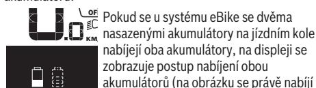
**U.0 km** Pokud se u systému eBike se dvěma nasazenými akumulátoři na jízdním kole nabíjejí oba akumulátoři, na displeji se zobrazuje postup nabíjení obou akumulátorů (na obrázku se právě nabíjí levý akumulátor). To, který z obou akumulátorů se právě nabíjí, poznáte také podle blikajícího ukazatele na akumulátoru.
