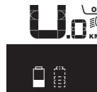
Ha az eBike-ra két akku van behelyezve, és mindenkitől a kerékpáron tölti, akkor a kijelzőn mindenkit akku töltésének előrehaladása megjelenik (az ábrán éppen a bal oldali akku töltése folyik). Az akku villogó jelzéséről megismerheti, hogy a két akkumulátor közül melyik akkumulátor töltése folyik éppen.
