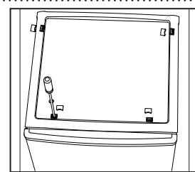
2. Odskrutkujte horný záves pomocou krížového skrutkovača.
