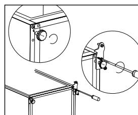
8. Odkręć i wyjmij dolny sworzeń zawiasu, odwróć wspornik i wymień go.
