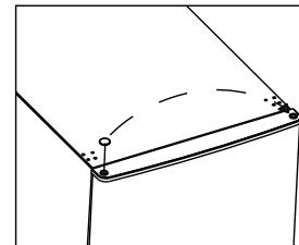
5. Odšroubujte prostřední závěs a poté zvedněte spodní dvířka a položte je na měkkou podložku, aby nedošlo k poškrábání.
