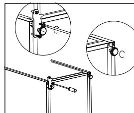
10. Postavte chladničku a nasadťte dvere na spodný záves. Uistite sa, že čap spodného závesu je zasunutý do spodného otvoru dverí. Potom presuňte kryt otvoru dolných dverí z ľavej strany na pravú stranu.
