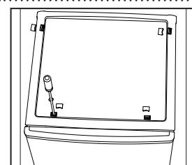
2. Odšroubujte horní závěs pomocí křížového šroubováku.
