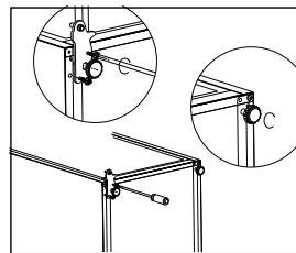
10. Postavte chladničku a nasaděte dveře na spodní závěs. Ujistěte se, že čep spodního závěsu je zasunut do spodního otvoru dveří. Poté přesuňte kryt otvoru dolních dveří z levé strany na pravou stranu.
