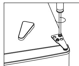
3. Odstráňte kryt otvoru plochým skrutkovačom.
