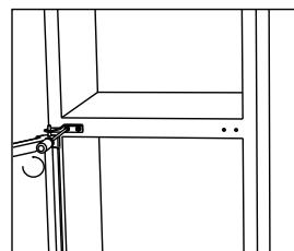
12. Namontujte horní dvířka s horním závěsem.
