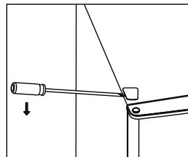
4. Presuňte kryt otvoru pre pánt zľava doprava. Potom zdvihnite horné dvierka a umiestnite ich na mäkký povrch, aby sa zabránilo poškriabaniu.
