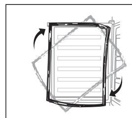
9. Odstawić urządzenie i założyć drzwi na dolny zawias. Upewnij się, że rdzeń zawisu dolnego jest włożony do drzwi otwór. Zamontuj drzwi z górnym zawiasem.
