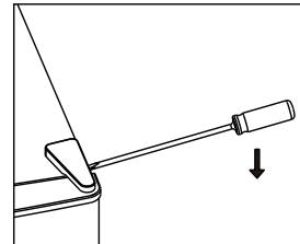
2. Odšroubujte horní závěs pomocí křížového šroubováku.
