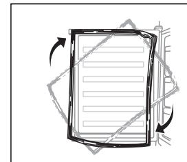
9. Postavte chladničku a nasadte dvere na spodný záves. Uistite sa, že čap spodného závesu je zasunutý do spodného otvoru dverí. Namontujte dvierka s horným závesom.
