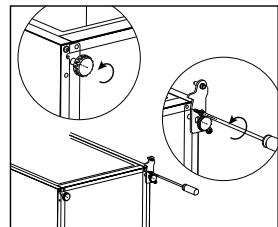
6. Odkręć i wyjmij dolny sworzeń zawiasu, odwróć wspornik i wymień go.
