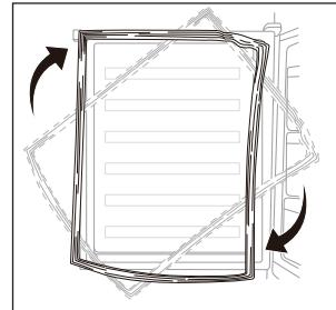
12. Vráťte dvere späť. Než definitívne dotiahnete skrutky, skontrolujte, či dvere horizontálne aj vertikálne doliehajú a či tesnenie po všetkých stranach správne dosadá.
