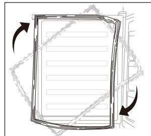
12. Vratte dveře zpět. Než definitivně dotáhnete šrouby, zkонтrolуйте, zda dveře horizontálně i vertikálně lícují a zda těsnění po všech stranách správně dosedá.
