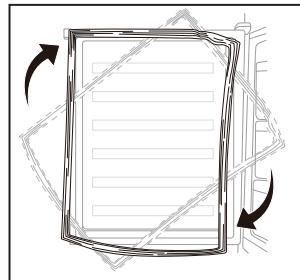
12. Helyezze vissza az ajtót! Mielőtt teljesen rögzíti a csavarokat, ellenőrizze az ajtó függőleges és vízszintes oldalát és a tömítés megfelelő működését!
