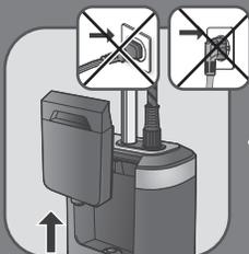
**FR** Débranchez l'appareil, et retirez le réservoir d'eau.
