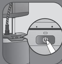
**FR** Appuyez longtemps sur le bouton ON/OFF afin d'éteindre l'appareil.
