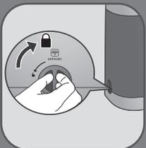
**SV** Sätt tillbaka tömningslocket, skruva fast det tills det är helt låst och kontrollera att det inte finns något läckage.
