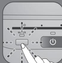
**FR** Si le bouton "Water" s'allume, le niveau d'eau dans le réservoir est faible et doit être rempli.
