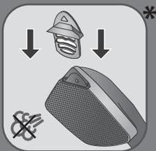
**FI** Työnnä lisävaruste höyrykotelon sisälle. Varmista, että laite on kylmä, eikä kehitä höyryä. Käytä MonParfum-lisävarustetta aina höyrykotelon sisälle työnnettynä. Voit käyttää sitä kankaan kanssa tai ilman.
