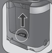
**FI** Vesisäiliön alla oleva sieni voidaan irrottaa ja puhdistaa vesijohtovedellä.
