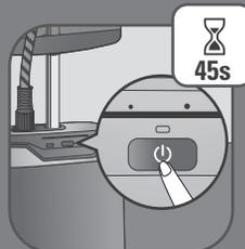
**SV** Tryck på PÅ/AV-knappen för att sätta på apparaten. Ångnivån blinkar på maximal nivå i 45 sekunder.
