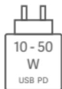
Moc dostarczana przez ładowarkę musi wynosić między minimalnie [10] W wymaganych przez urządzenie radiowe a maksymalnie [50] W, aby osiągnąć maksymalną prędkość ładowania. Szybkie ładowanie USB PD.
