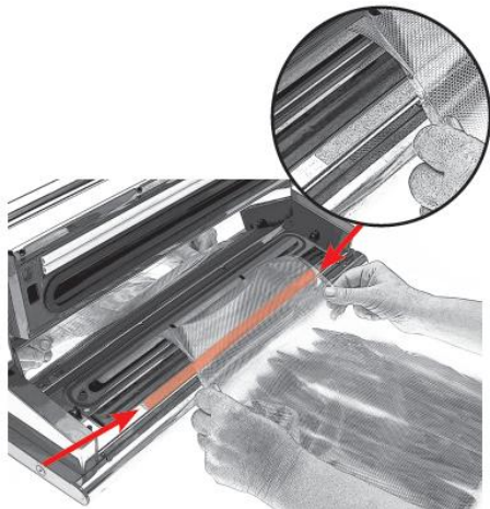
Obrázek 4: vždy položte sáček na pásku Status Stiki pro snazší umístění sáčku.
