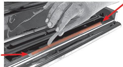
Obrázek 3: před přilepením pásky Stiki nezapomeňte vždy vyčistit povrch.
