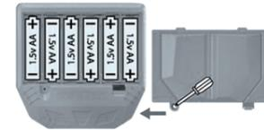
Použijte 6 ks baterií 1,5 V typu „AA“ (nejsou součástí) / Použite 6 ks batérií 1,5 V typu „AA“ (nie sú súčasťou)
