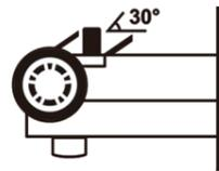
Když vložíte autíčko na dráhu, ujistěte se, že vodící sloupek na podvozku je umístěn do rýhy závodní dráhy, a že se kartáček dotýká železných vodičů na dráze. / Keď vložíte autíčko na dráhu, uistite sa, že vodiace stĺpik na podvozku je umiestnený do ryhy pretekárske dráhy, a že sa kefka dotýka železných vodičov na dráhe.
