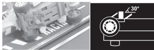
Zahněte kartáček tak, aby s podvozkom svíral přibližně úhel 30°. / Zohnite kefku tak, aby s podvozkom zvierala približne uhol 30°.
