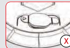
Nesprávná instalace pryžové zátky zásobníku na vodu
