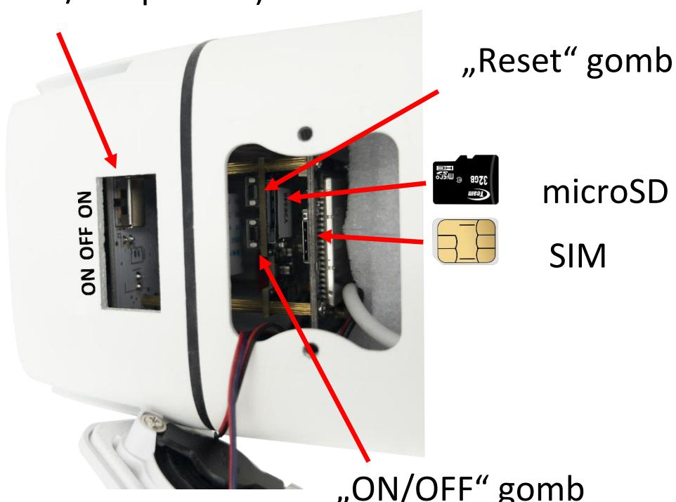
A kamerába legfeljebb 64 GB kapacitású SD-kártyát ("microSD" méretű) helyezhet be. Behelyezéskor fordítsa a SD kártyát az érintkezőivel az elektronikai lap felé. SD kártya nem szükséges a kamera működéséhez.
