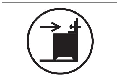
1. Nainstalujte ochranu proti překlopení B - 343 mm pod úrovňí horní plochy spotřebiče a A - 67 mm od boční strany spotřebiče skrze kruhový otvor na konzoli. Přišroubujte jej do pevného
