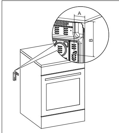
2. Tento otvor naleznete na levé straně zadní části spotřebiče. Nadzdvíhněte přední stranu spotřebiče a umístěte ji doprostřed prostoru mezi kuchyňskými skříňkami. Jestliže je prostor mezi pracovními plochami kuchyňské linky větší než šířka spotřebiče, pak je třeba upravit boční rozměry směrem ke středu spotřebiče.
