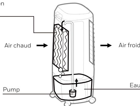
Le taux d'humidité relative maximal recommandé est de 60% ou moins, ce qui permet une diminution perceptible de la température. La température sera plus faible en climat sec, car une plus grande évaporation se produit lorsque l'humidité est faible.
