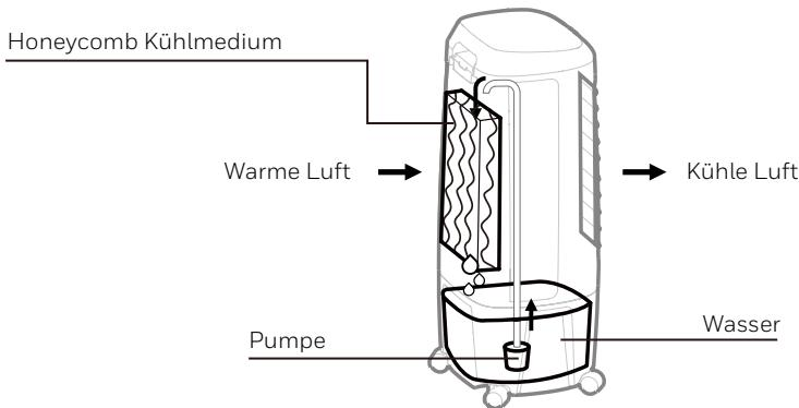
Die empfohlene maximale relative Luftfeuchtigkeit ist 60% oder weniger, was eine merkliche Temperatursenkung erlaubt. Die Temperatur wird in trockeneren Klimazonen niedriger sein, weil eine höhere Verdampfung auftritt wenn die Luftfeuchtigkeit niedrig ist.
