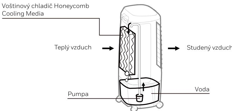
Doporučená maximální relativní vlhkost vzduchu je 60 % nebo méně, což umožňuje znatelné snížení teploty. V suším prostředí bude teplota nižší, protože při nižší vlhkosti se zvýší množství odpařené vody.
