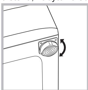
Dokonalé vyrovnanie do vodorovnej polohy zabezpečí stabilitu zariadenia a zamedzí vzniku vibrácií a hluku počas činnosti. V prípade inštalácie na podlahovú krytinu alebo na koberec, nastavte nožičky tak, aby pod práčkou zostal dostatočný voľný priestor na ventiláciu.
