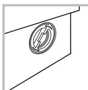
2. Odskrutkujte veko otáčaním proti smeru hodinových ručičiek (viď obrázok): výtečenie malého množstva vody je úplne bežným javom;
