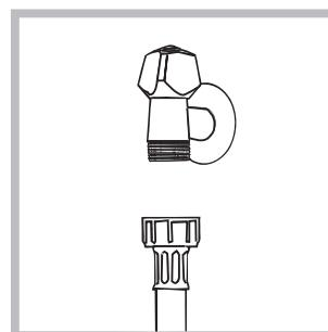
1. Pripojte prívodnú hadicu jej zaskrutkovaním ku kohútiku so studenou vodou, s hrdom so závitom 3/4" (viď obrázok). Pred pripojením hadice nechajte vodu odtieť, až kým nebude číra.
