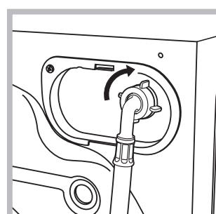
2. Pripojte prítokovú hadicu k práčke, jej zaskrutkovaním k príslušnej prípojke na vodu, umiestnenej vpravo hore (viď obrázok).
