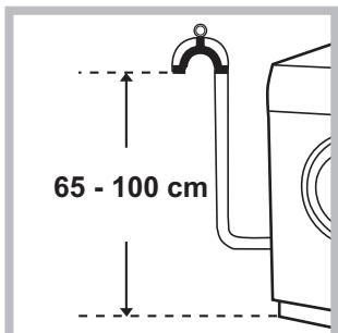
Připojte vypouštěcí hadici k odpadovému potrubí nebo k odpadu ve stěně, který se nachází od 65 do 100 cm nad zemí; zamezte jejímu ohybu
