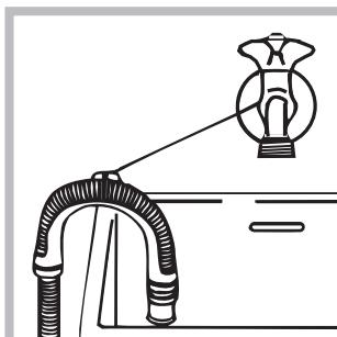
oder hängen Sie diesen in ein Becken oder eine Wanne ein; befestigen Sie den Schlauch in diesem Falle mittels der mitgelieferten Führung an dem Wasserhahn (siehe Abbildung). Das freie Ablaufschlauchende darf nicht unter Wasser bleiben.
