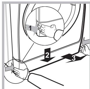
3. свалете долния панел в предната част на пералната машина с помощта на отвертка (вж. фигура).
