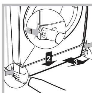
1. Odložte krycí panel na prednej strane zariadenia zatlačením na jeho stred a následným zatlačením smerom nadol z obidvoch strán a potom ho vytiahnite (viď obrázky).
