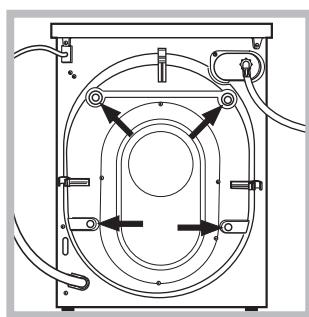
3. Отстранете 4-те защитни винта за предпазване при превоза и гумираната опаковка със съответния раздалечител, намиращи се в задната част (вижте фигурата).
