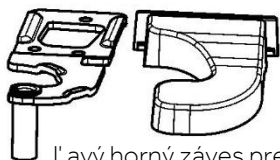
Ľavý horný záves pre otočenie dverí
