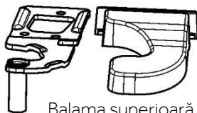
Balama superioară stângă pentru inversarea ușii
