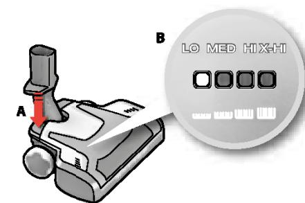
**3. Височината на почистване за килими може да се регулира чрез натискане на педала за регулиране на височината в задната част на дюзата, използвайки ръка или крак (A). Индикаторът за височината се променя от Low на X-Hi (B), докато извършвате регулацията за задаване на подходящо разстояние между повърхността на пода и четката.**
