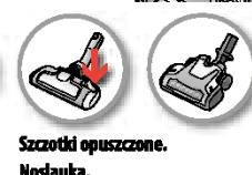
Nie zaleca się używania ssawki na twardych podłogach ze szczełinami. Jeśli się jej jednak używa na takich powierzchniach, należy wyłączyć szczotkę obrotową, aby nie uszkodzić podłogi.
