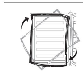
9. Postavte chladničku a nasadte dveře na spodní závěs. Ujistěte se, že čep spodního závěsu je zasunut do spodního otvoru dveří. Namontujte dvířka s horním závěsem
