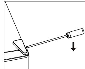
2. Odšroubujte horní závěs pomocí křížového šroubováku.
