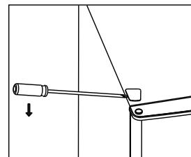
4. Přesuňte kryt otvoru pro pant zleva doprava.
