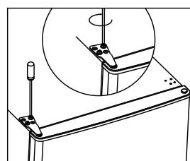
10. Zaklapněte kryt závěsů a kryt otvoru na horní části chladničky.
