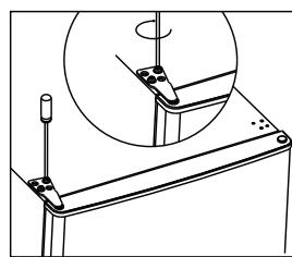
10. Zatrzaśnij pokrywę zawiasów i pokrywę gniazda na górze urządzenia.
