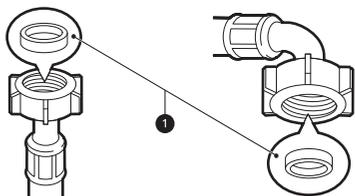
**Pripojenie hadice k vodovodnému kohútiku****Pripojenie hadice skrutkovacieho typu k prívodu vody so závitom**
