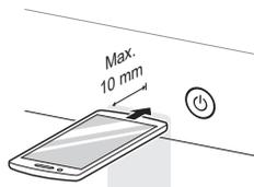
**3** Po dobu 3 sekúnd alebo dlhšie stlačte a podržte tlačidlo **Teplota** a zároveň držte mikrofón smartfónu pri tlačidle **Napájanie**, kým sa prenos dát neskončí.
