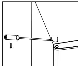
4. Přesuňte kryt otvoru pro pant zleva doprava.
