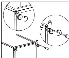
6. Odkręć i wyjmij dolny sworzeń zawiasu, odwróć wspornik i wymień go.
