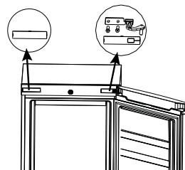
2. Odskrutkujte horný záves pomocou krížového skrutkovača.
