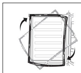
9. Odstawić urządzenie i założyć drzwi na dolny zawias. Upewnij się, że rdzeń zawiasu dolnego jest włożony do drzwi otwór. Zamontuj drzwi z górnym zawiasem.
