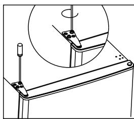
10. Zatrzaśnij pokrywę zawiasów i pokrywę gniazda na górze urządzenia.
