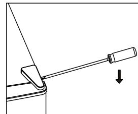
2. Odšroubujte horní závěs pomocí křížového šroubováku.
