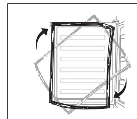
9. Postavte chladničku a nasadťte dvere na spodný záves. Uistite sa, že čap spodného závesu je zasunutý do spodného otvoru dverí. Namontujte dvierka s horným závesom.
