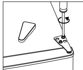
3. Odstráňte kryt otvoru plochým skrutkovačom.
