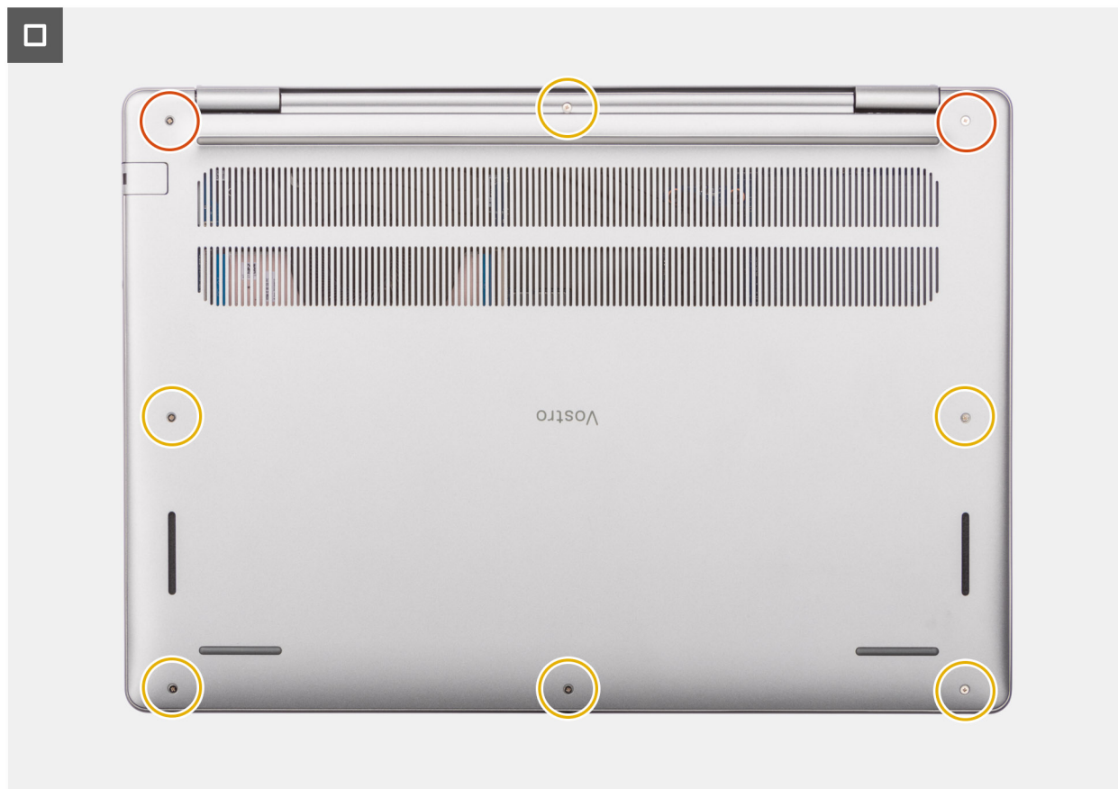
Obrázek 17. Nasazení spodního krytu
