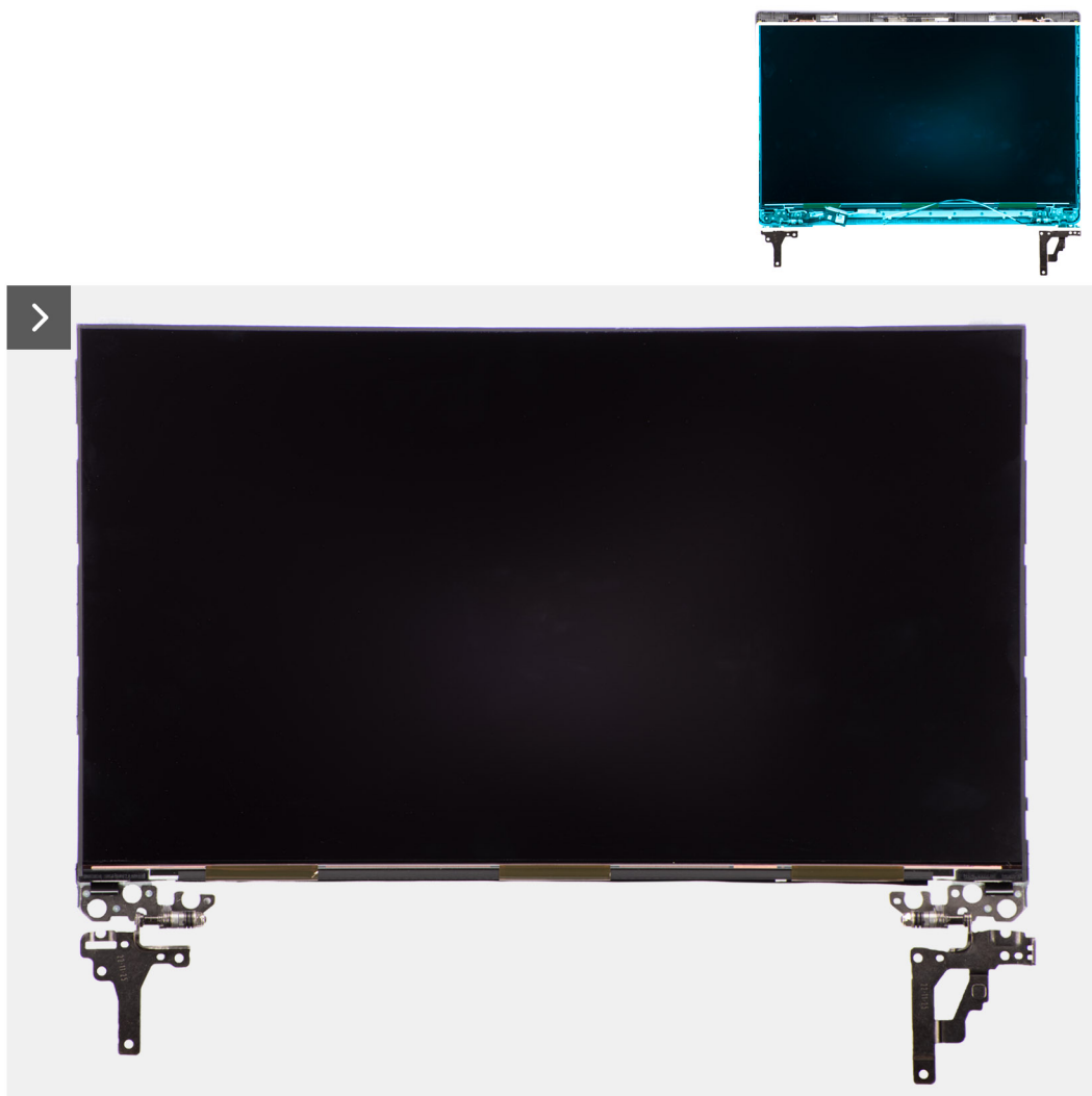
Obrázek 61. Montáž obrazovky displeje
