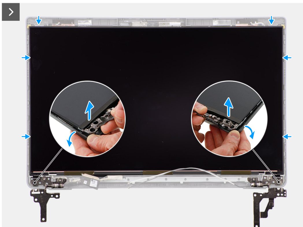
Obrázek 57. Demontáž obrazovky displeje
