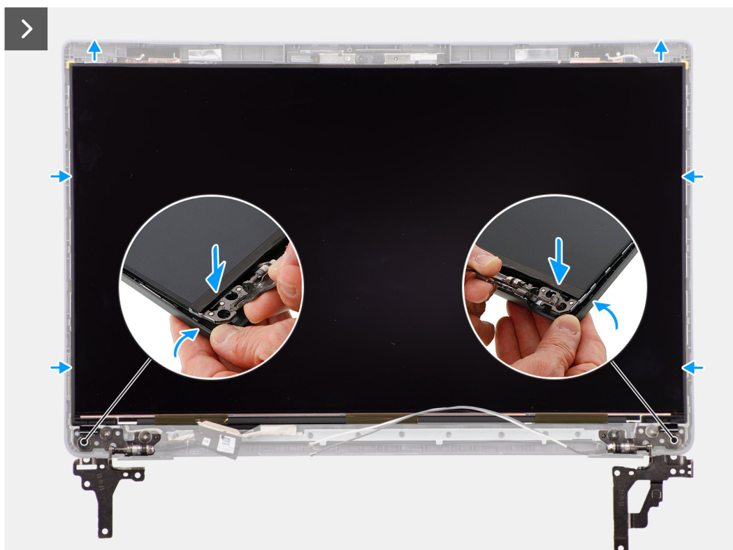
Obrázek 64. Montáž obrazovky displeje
