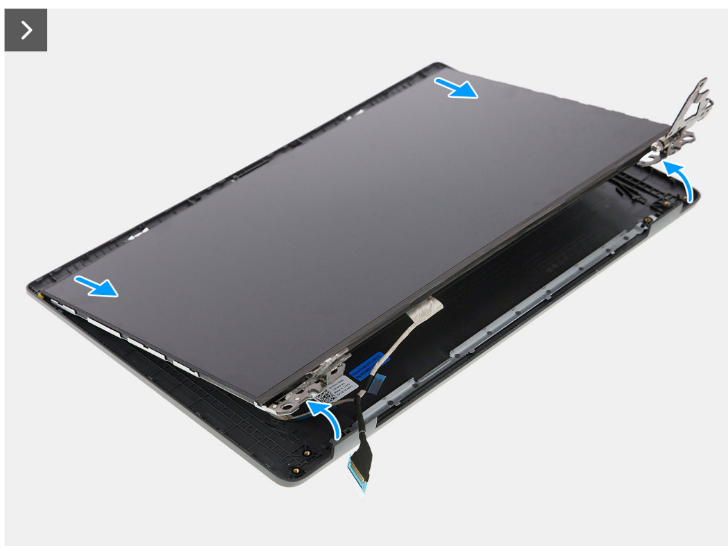
Obrázek 58. Demontáž obrazovky displeje
