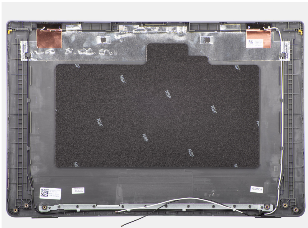
Obrázek 70. Demontáž zadního krytu displeje
