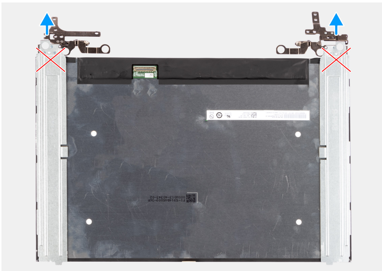
Obrázek 82. Demontáž obrazovky displeje
