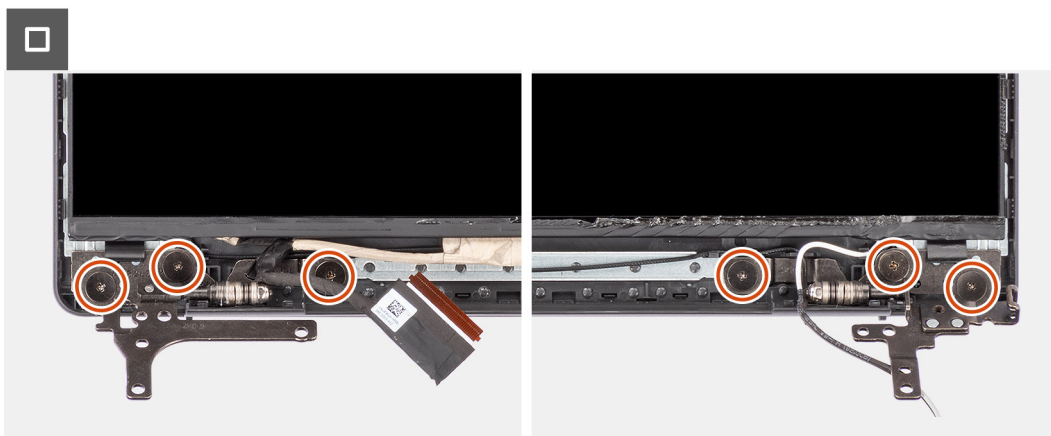
Obrázek 86. Montáž obrazovky displeje
