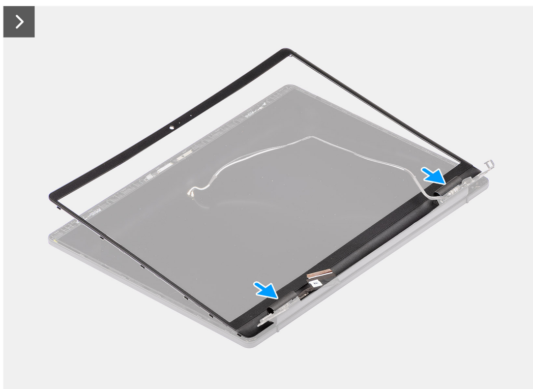
Obrázek 77. Montáž čelního krytu displeje
