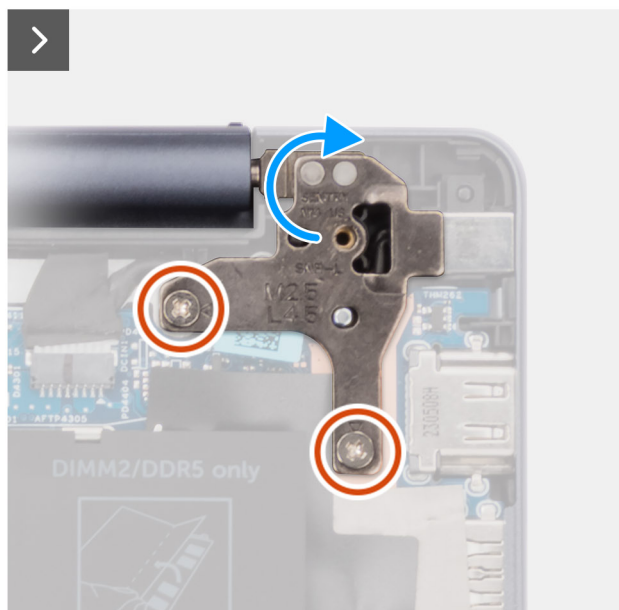
Obrázek 50. Vyjmutí portu napájecího adaptéru
