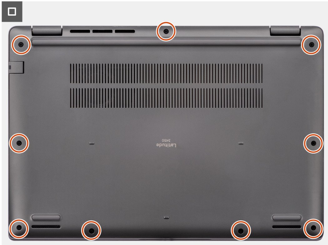
Obrázek 12. Nasazení spodního krytu
