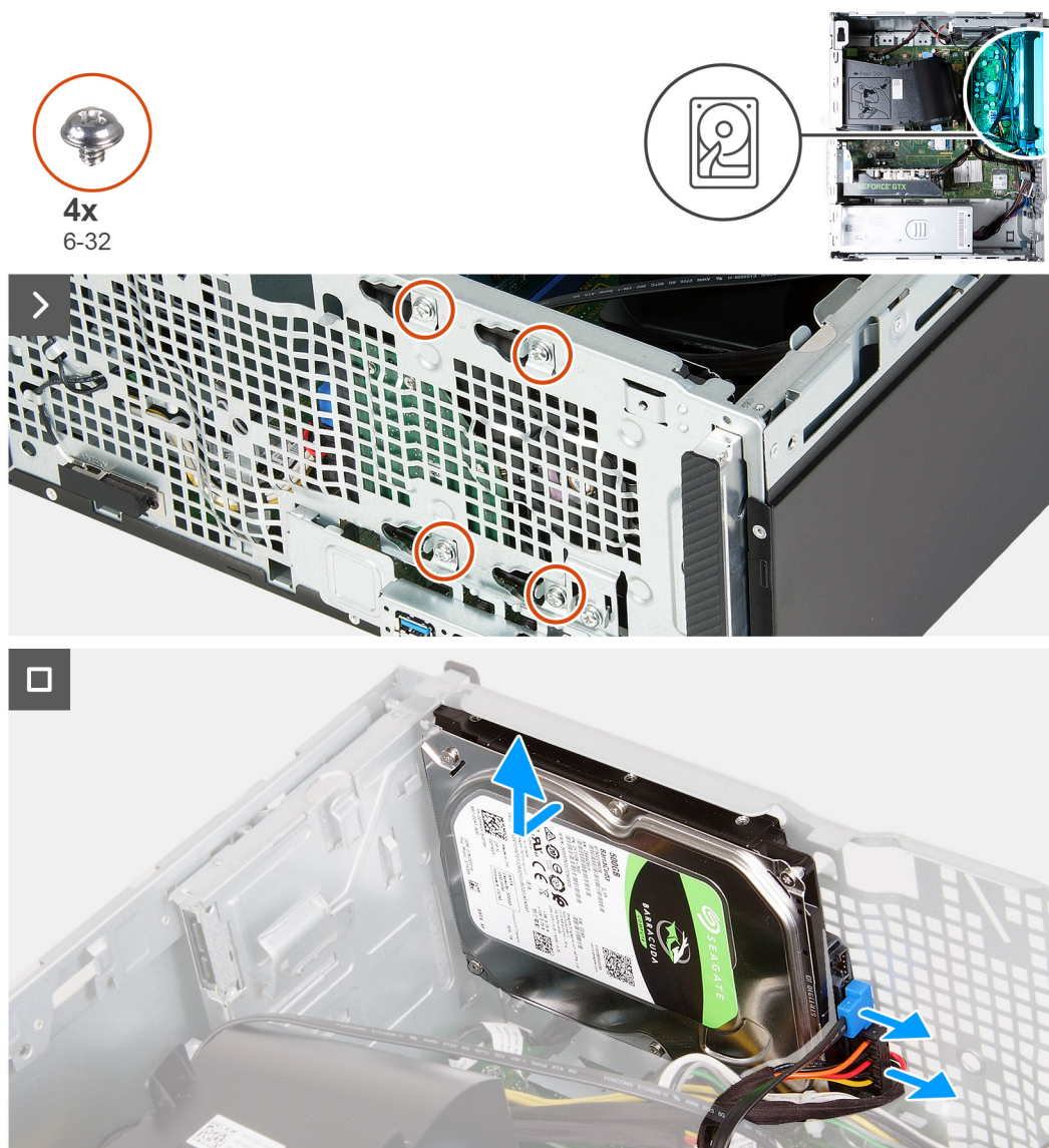
Obrázek 24. Demontáž pevného disku
