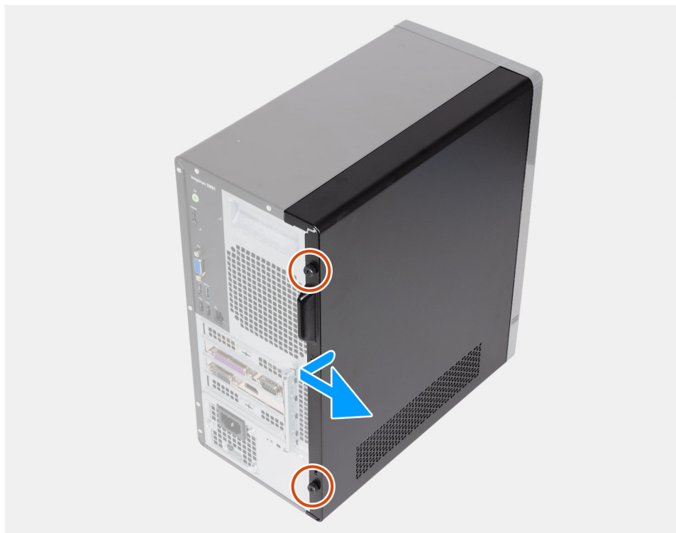
Obrázek 10. Demontáž levého bočního krytu
