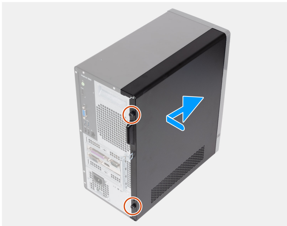
Obrázek 11. Montáž levého bočního krytu
