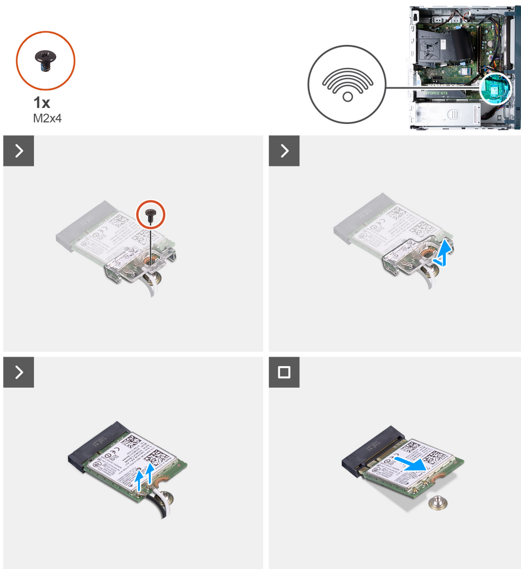
Obrázek 20. Demontáž bezdrátové karty
