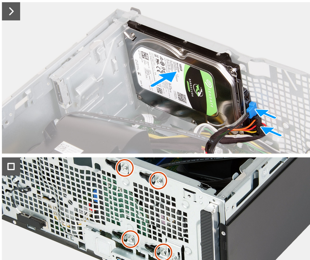
Obrázek 25. Montáž pevného disku
