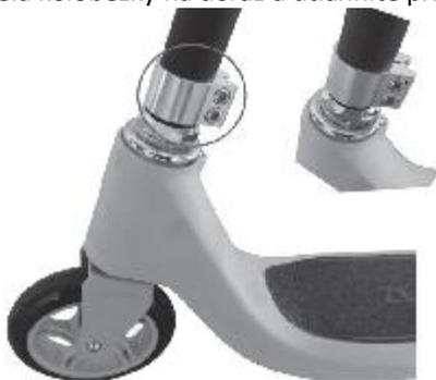
2. Vložte říditka do objímky na vrcholu řídicí tyče a pomocí přiloženého nářadí utáhněte příslušné šrouby. Dbejte na správnou orientaci a vycentrování řídítek vůči jezdcí. / Vložte riadidlá do objímky na vrchole riadiacej tyče a pomocou priloženého náradia utiahnite príslušné skrutky. Dbajte na správnu orientáciu a vycentrovanie riadidiel voči jazdci.
